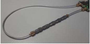
Измерение аттенюаторов с общим затуханием 100 и 110 дБ в режиме измерителя АЧХ, ФЧХ. Прибор откалиброван с высоким уровнем генератора (+10 дБм). При измерении включена медленная скорость развёртки (5 с/дел) для получения минимальной полосы пропускания приёмника (RBW = 11,9 Гц). Данные настройки позволяют получить максимальный динамический диапазон.
