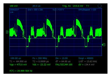
Осциллограмма видеосигнала РАL. Синхронизация по 100-й строке. Частотомер работает по условию синхронизации и с высокой точностью измеряет частоту кадров (частоту появления 100-ой строки).
